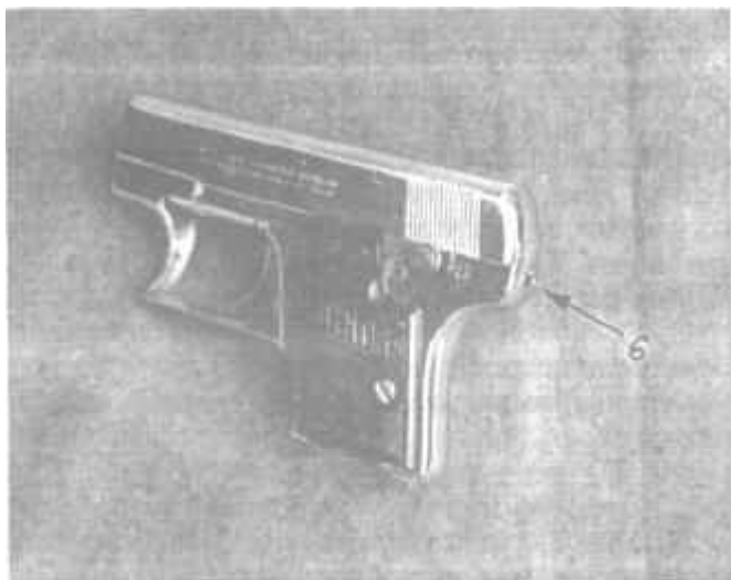
Фото 59. Указатель патрона в патроннике 6 выдвинут. Пистолет заряжен
