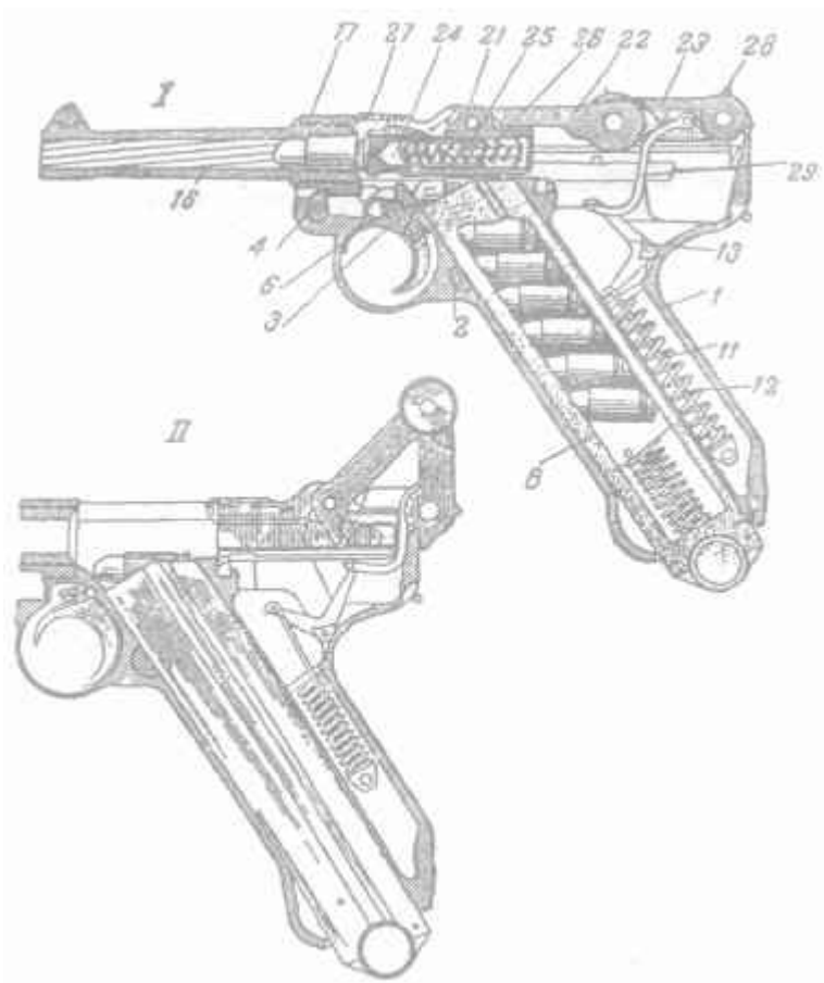
Схема 6. Разрез пистолета по оси:
